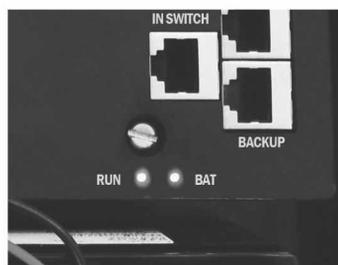
Sua alimentação é realizada por todos os clientes conectados ao mesmo, sendo que na falta de energia POE vindo de um cliente, o PD desabilita os dados do respectivo cliente, como forma de proteção do equipamento e ascende um LED vermelho indicando uma falha da respectiva porta. Na falta de energia de todos os clientes o PD UTP GIGA ainda continuará mantendo o sistema ativo através do circuito nobreak, por até 8 horas
