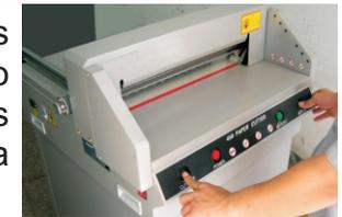
Assim que a prensa tocar as folhas tire o dedo do botão "CUT", do contrário a máquina continuará o processo e em seguida descerá a faca que cortará as folhas. Se você quer levantar a prensa, você deve pressionar o botão "CUT" do lado esquerdo do painel e apertar o botão "RESET", assim a prensa voltará automaticamente para sua posição inicial. Pressione os botões "CUT" utilizando ambas as mãos e mantenha os botões pressionados para cortar seu material.
