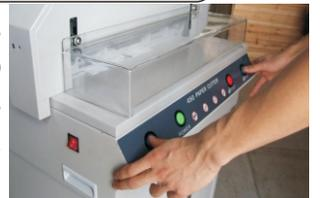
Assim que a prensa tocar as folhas tire o dedo do botão “CUT”, do contrário a máquina continuará o processo e em seguida descerá a faca que cortará as folhas. Se você quer levantar a prensa, você deve pressionar o botão “CUT” do lado esquerdo do painel e apertar o botão “RESET”, assim a prensa voltará automaticamente para sua posição inicial. Pressione os botões “CUT” utilizando ambas as mãos e mantenha os botões pressionados para cortar seu material.
