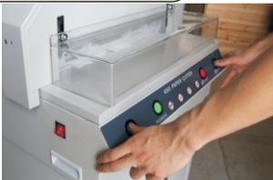
Assim que a prensa tocar as folhas tire o dedo do botão “CUT”, do contrário a máquina continuará o processo e em seguida descerá a faca que cortará as folhas. Se você quer levantar a prensa, você deve pressionar o botão “CUT” do lado esquerdo do painel e apertar o botão “RESET”, assim a prensa voltará automaticamente para sua posição inicial. Pressione os botões “CUT” utilizando ambas as mãos e mantenha os botões pressionados para cortar seu material.
