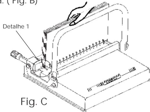
3- Após regulado o travessão traseiro, manter a alavanca aberta e encaixar o conjunto ( folhas, capas e duplo anel ), conforme Fig. C
