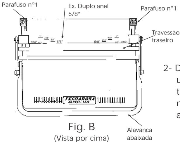
2- Definido o diâmetro do Duplo Anel a ser utilizado, e com a alavanca abaixada ajustar o travessão traseiro utilizando os parafusos de nº1 simultaneamente até atingir a escala desejada. ( Fig. B)
