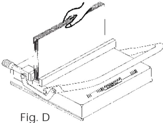
4- Assegure-se que o Duplo Anel está totalmente apoiado a base. ( Detalhe 1 )
