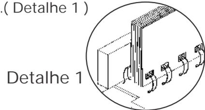
5- Abaixe a alavanca até o final para fechamento do Duplo Anel, conforme Fig. D
