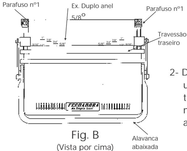
2- Definido o diâmetro do Duplo Anel a ser utilizado, e com a alavanca abaixada ajustar o travessão traseiro utilizando os parafusos de número 1 simultaneamente até atingir a escala desejada. ( Fig. B )
