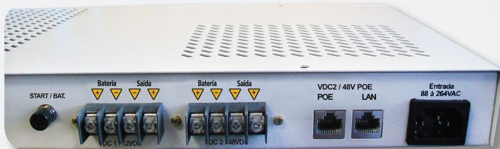
5. Desligue novamente o Retificador e faça as conexões da bateria 1 e da bateria 2. Use a figura abaixo como referência de montagem.
