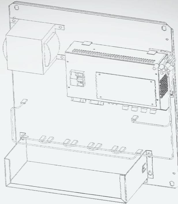
**PASSO 1- Colocar 4 baterias no suporte inferior deixando a do centro a ser colocada posteriormente;**
