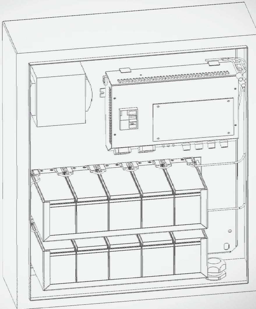
**IMPORTANTE:** *Acione o disjuntor por ultimo, isto após ter certificado a visualização do painel que existe alimentação de rede elétrica e do banco de baterias, desta forma, podemos acionar o disjuntor e alimentar os ramais.*
