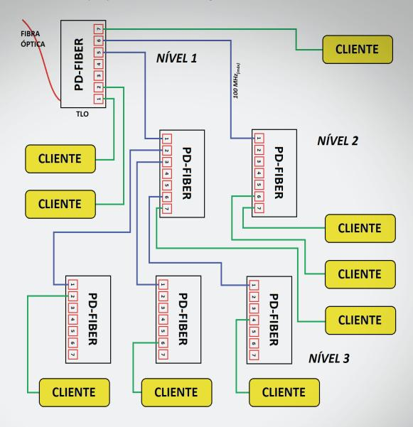
Observe que o Link de fibra óptica estará conectado apenas ao PD-FIBER do topo (Nível 1).
